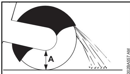
El procedimiento varía según el diámetro exterior del tubo y la profundidad máxima de corte del disco abrasivo (A).
