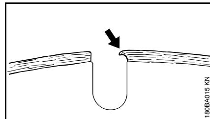
Si se continúa usando un disco con segmentos romos, éstos podrían ablandarse como resultado del calentamiento excesivo. El centro del disco también se sobrecalienta y pierde su resistencia mecánica. Esto puede causar esfuerzos grandes, los cuales se indican claramente por medio de las roturas de esfuerzo y/o movimientos de oscilación del disco.
