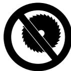
Nunca use discos de sierra circular, discos con puntas de carburo, discos reconstruidos, discos abrasivos para madera ni discos con dientes de tipo alguno. Pueden causar lesiones personales graves como resultado del contacto con la hoja de sierra o los objetos lanzados y/o las fuerzas reactivas, incluyendo el contragolpe. Vea la sección "Fuerzas reactivas". El concesionario STIHL tiene un inventario de discos abrasivos especiales para los diversos usos de la tronadora.
