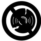
Inspeccione el disco abrasivo con frecuencia y sustitúyalo de inmediato si tiene roturas o combaduras. Los discos rotos o combados pueden romperse o quebrarse y causar lesiones personales graves o mortales. Los discos abrasivos deformados o desequilibrados pueden aumentar las vibraciones y acortar la vida útil de la tronadora
