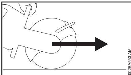
Las fuerzas reactivas más comunes son los culatazos y el trepado. Si el contacto se produce en la parte inferior del disco, la tronzadora intentará alejarse del operador (culatazo). Si el contacto se produce en el extremo delantero del disco, éste puede intentar "trepado" sobre el objeto cortado (trepado).
