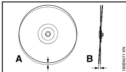
Un descentramiento radial (**A**) excesivo causa sobrecargas en segmentos adiamantados individuales y calor excesivo. Esto a su vez puede causar fracturas por esfuerzos en el centro del disco o el ablandamiento de segmentos individuales.
