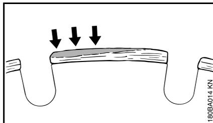
Los bordes con acumulaciones se identifican por medio de depósitos gris claro encima de los segmentos adiamantados que obturan y reducen el filo de los segmentos.
