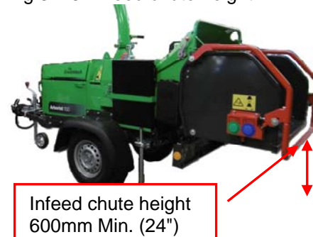
Fig 3.4.3 Infeed chute height
