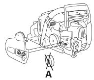
Positionner le guide-chaîne sur les écrous et l'amener à sa position la plus reculée. Placer la chaîne sur le pignon d'entraînement et dans la gorge du guidechaîne. Commencer par le dessus du guide.
