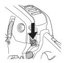
REMARQUE! Le bouton marche/arrêt retourne automatiquement en mode de conduite. Afin d'éviter tout démarrage accidentel, toujours retirer le capuchon de la bougie quand la machine n'est pas sous surveillance.
