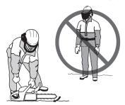
Tenez toujours la tronçonneuse à deux mains. Tenez la main droite sur la poignée arrière et la main gauche sur la poignée avant. Tous les utilisateurs, droitiers et gauchers, doivent la tenir ainsi. Tenez fermement en entourant la poignée de la tronçonneuse avec les pouces et les autres doigts.
