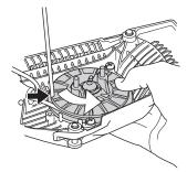
Déposer la vis au centre de la poulie et enlever la poulie. Installer et bloquer une nouvelle corde sur la poulie. Enrouler la corde d'environ 3 tours sur la poulie. Monter la poulie contre le ressort de rappel, de manière à ce que l'extrémité du ressort s'engage dans la poulie. Reposer la vis dans le centre de la poulie. Passer la corde à travers le trou du boîtier du lanceur et dans la poignée. Faire un nœud robuste à l'extrémité de la corde.
