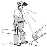
5 Observer la plus grande prudence lors de l'abattage des arbres sous tension. Avant et après le sciage, les arbres sous tension risquent de brutalement retrouver leur position initiale. Un mauvais placement de l'utilisateur ou de l'entaille d'abattage peut entraîner un choc avec l'arbre pouvant résulter en une chute ou en une perte du contrôle de la machine. Ces deux cas de figure sont susceptibles de provoquer des blessures graves.
