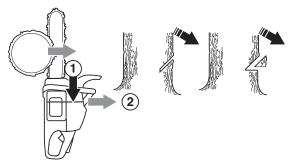
L'encoche doit faire 1/4 du diamètre du tronc et l'angle entre les deux entailles doit être d'au moins 45°.
