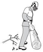
Ne se déplacer qu'avec le tronc entre soi et la tronçonneuse.
