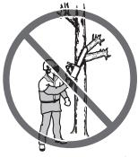
5 Afin de conserver le contrôle de la tronçonneuse, toujours conserver une position stable. Ne jamais travailler sur une échelle, dans un arbre ou sur tout autre support ne garantissant pas une bonne sécurité.
