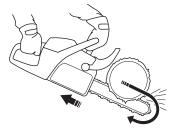
8 Il importe de résister à la poussée en arrière du guidechaîne. En effet, si le guide-chaîne est repoussé suffisamment en arrière pour que la zone de rebond du nez se trouve en contact avec l'arbre, un rebond peut se produire.
