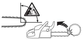
Le tronçonnage avec la partie inférieure de la chaîne, c'est à dire par dessus (de haut en bas), s'appelle méthode "poussée". La tronçonneuse est attirée vers l'arbre et le bord avant de la tronçonneuse devient un appui naturel contre l'arbre. Dans ce cas, l'utilisateur contrôle mieux à la fois sa tronçonneuse et la zone de rebond du nez.
