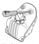
Certains silencieux sont munis d'une grille antiflamme. Cette grille doit être nettoyée une fois par semaine si la machine en est équipée. Utiliser de préférence une brosse en acier. Un pare-étincelles colmaté risque de causer la surchauffe du moteur et de provoquer de sérieuses avaries du moteur.
